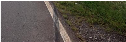
La huella de frenado de las llantas izquierdas
